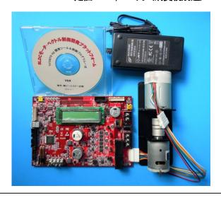
ベクトル・エンジン搭載ARM Cortex W4F マイコン TMPM475FDFG ブラシレスDCモータ・ベクトル制御開発
